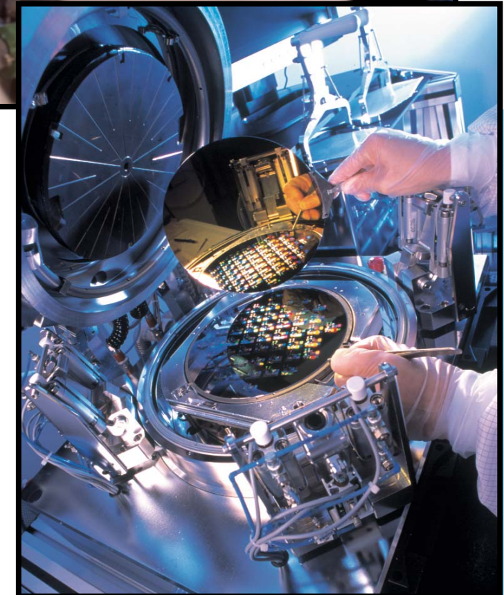
Photo page de gauche : nanostructures sur substrats de silicium, obtenues en enchaînant une étape de lithographie par nano-impression et une étape de gravure plasma dans le silicium. Photo page de droite : nanolithographie : introduction d'un moule en silicium dans une presse utilisée pour la nano-impression.
